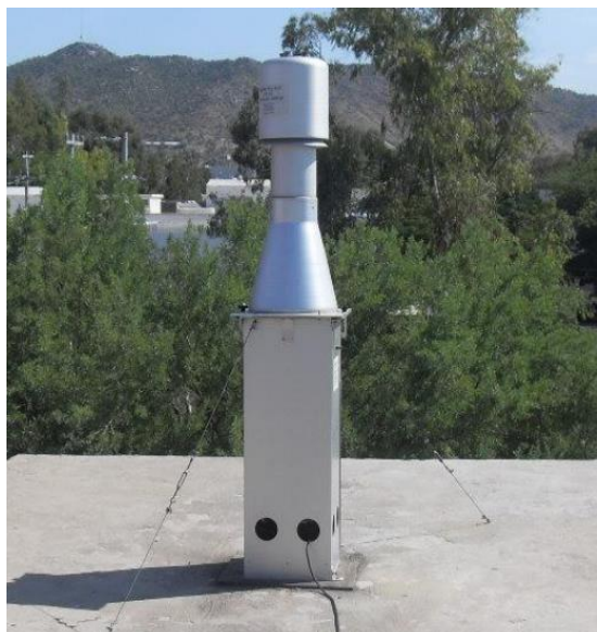
Figura 7. Muestreador de alto volumen wedding 600.
